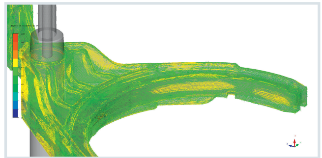
Bild 4. Der hohe Orientierungsgrad der Fasern verstärkt die Belastbarkeit des Bauteils und verringert die Schwindung in Faserrichtung (© GK Concept)
